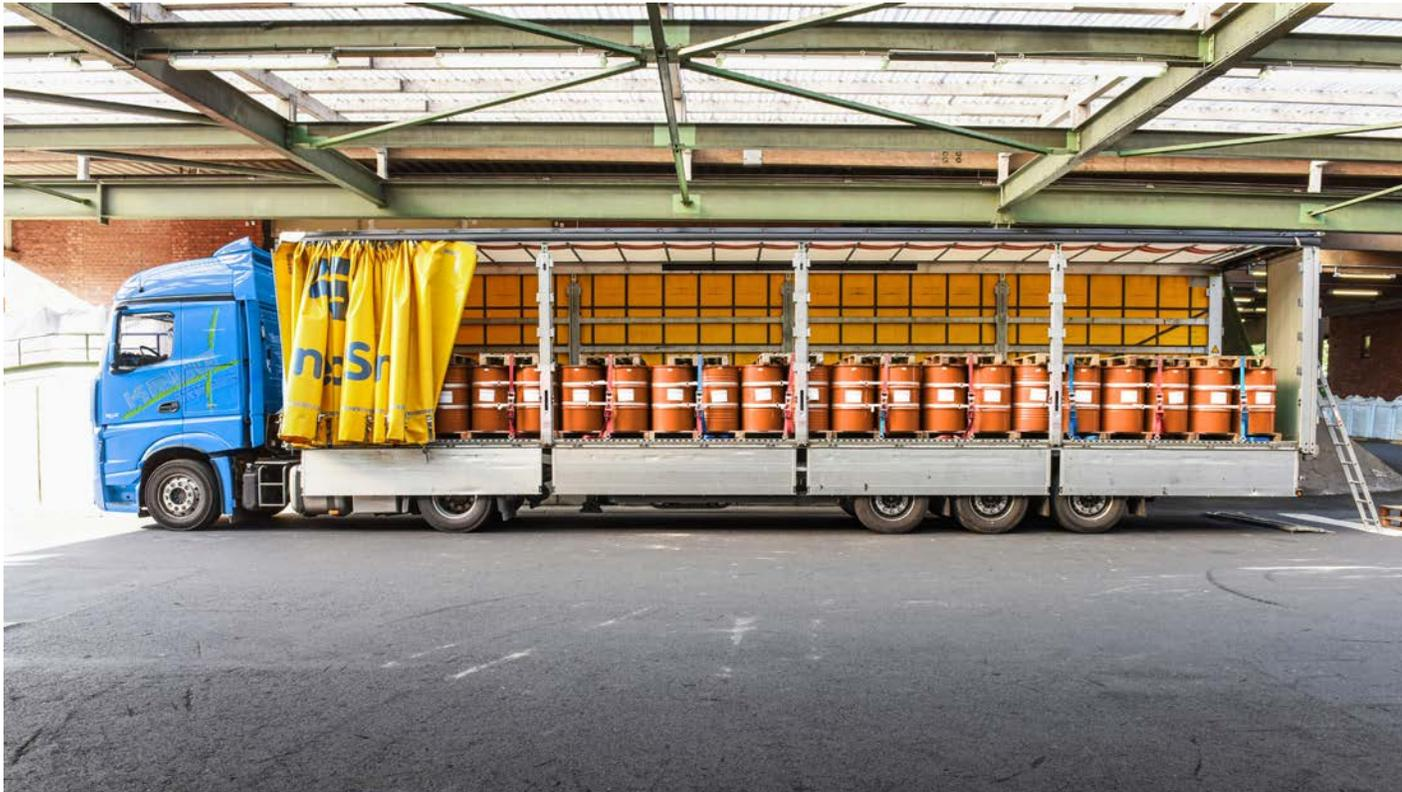
Bild: Beispiel, seitlich entladbarer Planen-LKW
